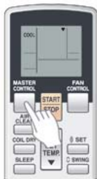
Eksempel: Varmepumpe satt til aircondition (cooling).
